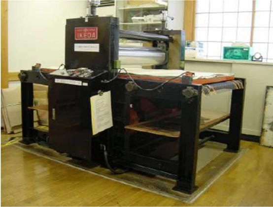
型 式 : 手動押バネ加圧型電動駆動式
