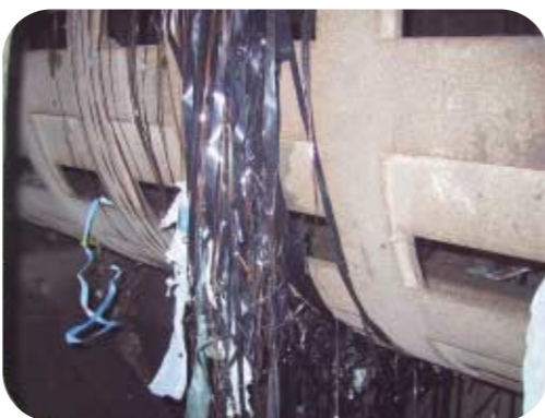
破砕機にからまったテープ (機械を止めなければ取れません)
